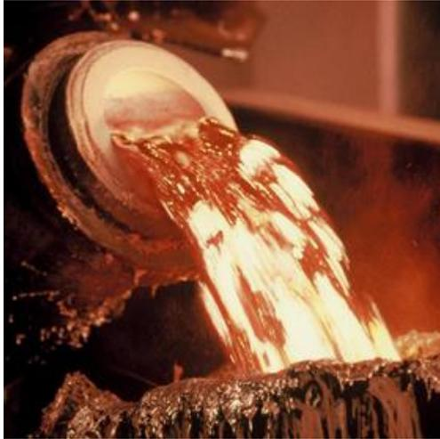
Kentucky 에 있는 Century Aluminum 은 미국 최대의 알루미늄 제련소 중 하나이다. 알루미늄 제조는 보크사이트 광석을 가지고 하는데, 보크사이트 광석은 전도성과 전해성을 유지하도록 하기 위한 여러가지 물질과 함께 pots 에서 용해된다. Pots 가 충분히 달궈져 내용물이 녹게 되면 cruces 라는 커다란 용기로 옮겨진다. Cruces 에 있던 내용물은 ingot 과 pig mould 를 거쳐 제조사들에게 판매된다.
